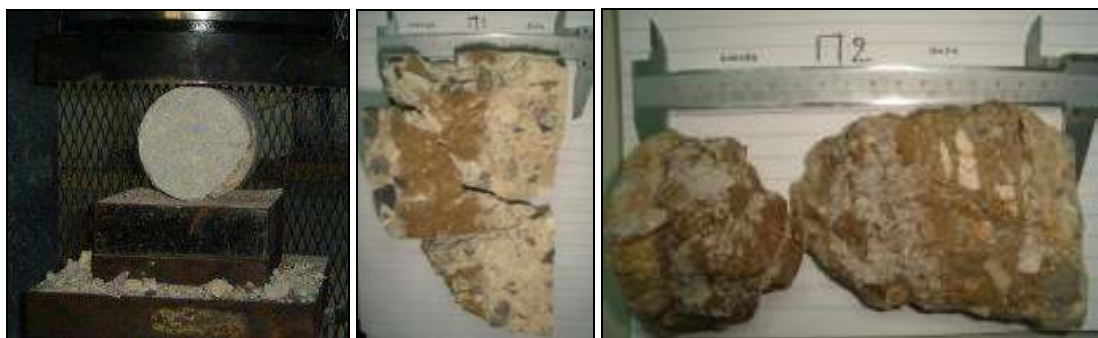
Εικόνα 12 (α) Θραύση δοκιμίου σε έμμεσο εφελκυσμό, (β) βάθος διείσδυσης χλωριόντων μετά τον ψεκασμό για τον πυρήνα Π1 και (γ) για τον πυρήνα Π2
