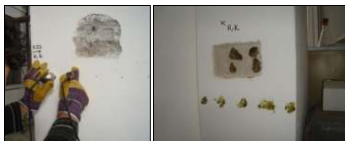
Εικόνα 27 Διεξαγωγή μετρήσεων χρόνου μετάδοσης υπερήχων
