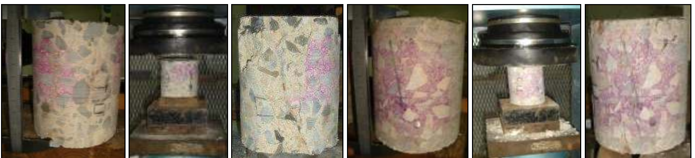
Εικόνα 11 Δοκίμιο ελέγχου, δοκιμή θραύσης και ρηγματωμένο δοκίμιο από τους πυρήνες Π1 (α), (β), (γ) και Π2 (δ), (ε), (στ) – Διακρίνεται και ο κάτω οπλισμός στον πυρήνα Π2.
