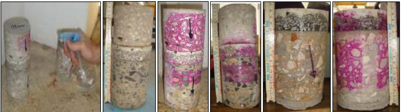
Εικόνα 10 (α) Ψεκάσμος με φαινολοφθαλείνη, (β) πυρήνας Π1 πριν τον ψεκάσμο, (γ), (δ) Πυρήνας Π1 μετά τον ψεκάσμο (όπου και διακρίνεται ο κάτω οπλισμός της πλάκας καθώς και οπλισμός πλέγματος στο υπερκείμενο γέμισμα), (ε) Πυρήνας Π2 πριν τον ψεκάσμο, (στ) μετά τον ψεκάσμο
