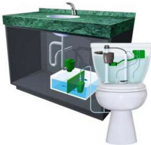
Εικόνα 2-14 Μικρής κλίμακας εγκατάσταση ανακύκλωσης γκρίζου νερού 3
