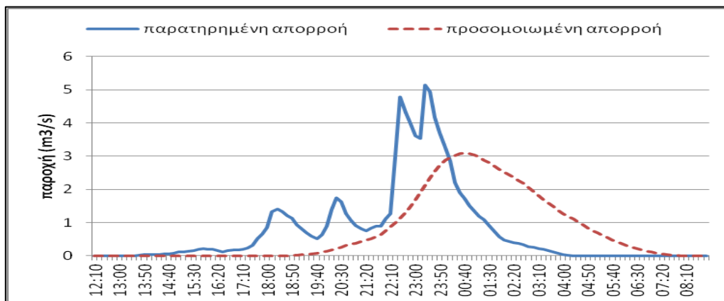
Γράφημα 5.19 Πλημμυρογράφημα παρατηρημένης άμεσης απορροής και προσομοιωμένης απορροής σύμφωνα με το μοναδιαίο υδρογράφημα του Βρετανικού Ινστιτούτου Υδρολογίας για \alpha=0,2 και CN=56,27 για την πλημμύρα στις 23/03/2007 για τη λεκάνη απορροής ανάντη στο Ντράφι
