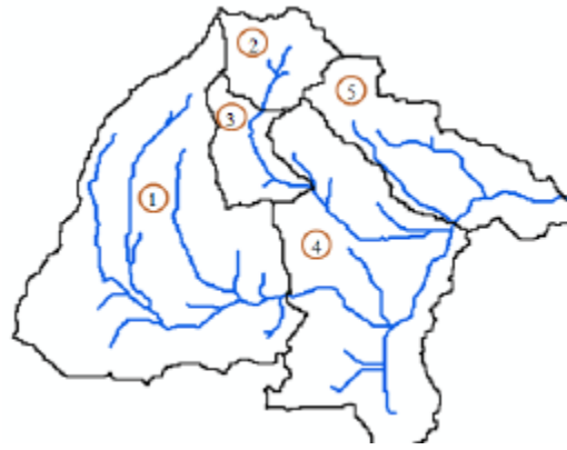
Σχήμα 3.8 Οι 5 υπολεκάνες της λεκάνης απορροής Ραφήνας όπως προσδιορίστηκαν από το πρόγραμμα Hec-Hms ( Πηγή : Alonistioti et al, 2011)
