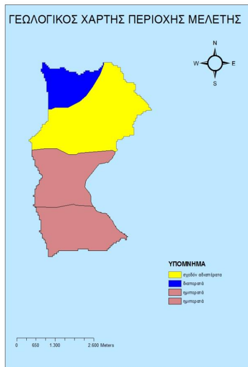
Σχήμα 3.6 Γεωλογικός χάρτης όπου εμφανίζεται η περατότητα των γεωλογικών σχηματισμών
