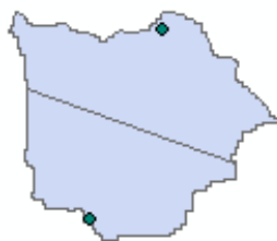
Σχήμα 4.6 Ζώνες επιρροής των σταθμών Μπάλα και Άγιο Νικόλαο στη λεκάνη ανάντη του σταθμού Λυκόρεμα
