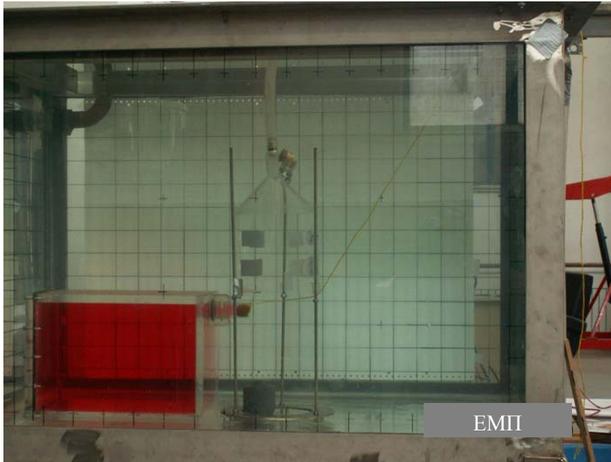
Σχήμα 4-5: Άποψη της διάταξης με το δοχείου γλυκού νερού βυθισμένο στη δεξαμενή με το αλατόνερο.
