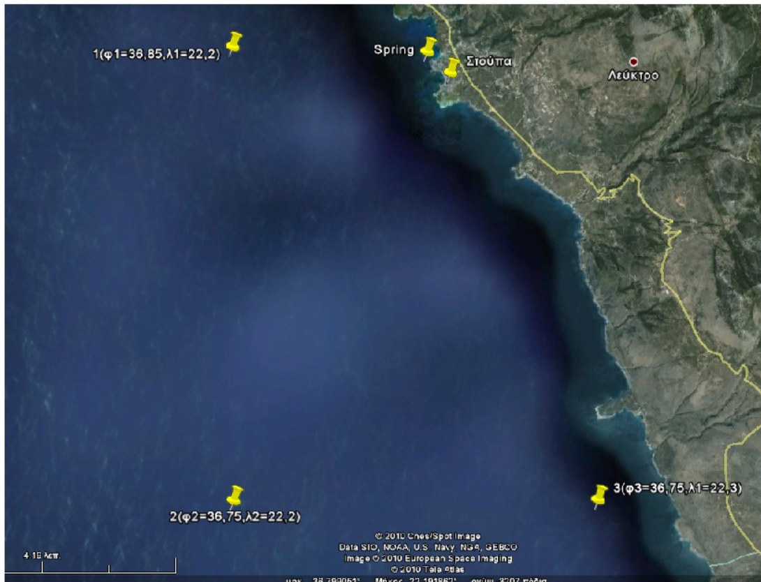
Σχήμα 2-9: Τα πλησιέστερα στην ανάβλυση σημεία (1,2,3) του πλέγματος του WAM
