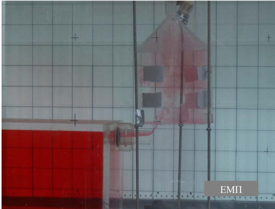
Σχήμα 4-10: Χαρακτηριστική εικόνα πειράματος σχετικά με τη μελέτη της ροής γλυκού νερού από στόμιο όπου παρατηρείται διείσδυση αλατόνερου από τον αποδέκτη.
