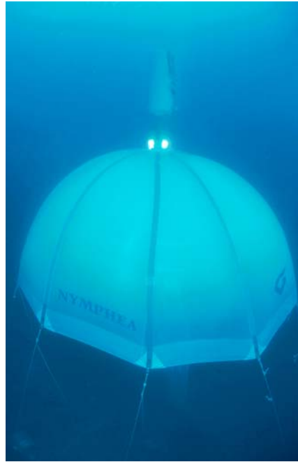
Σχήμα 1-1: Διάταξη συλλογής νερού από υποθαλάσσια πηγή (φωτογραφία από Bakalowicz et al. 2003).
