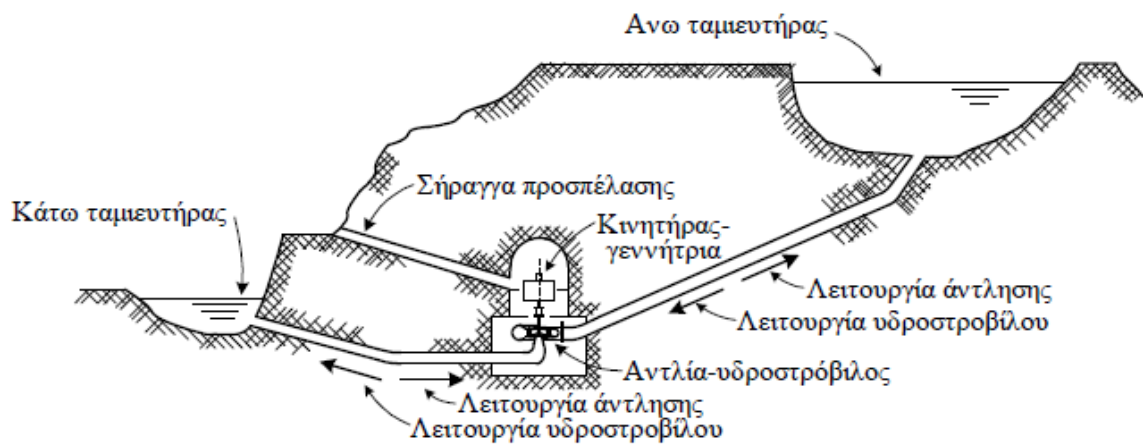
Εικόνα 2-9: Σχηματική απεικόνιση της λειτουργίας ενός έργου άντλησης/ταμιεύσης. Εικονίζονται οι δύο ταμιευτήρες και τα αντίστοιχα έργα προσαγωγής-άντλησης-παραγωγής (Ρεντζής, 2013).
