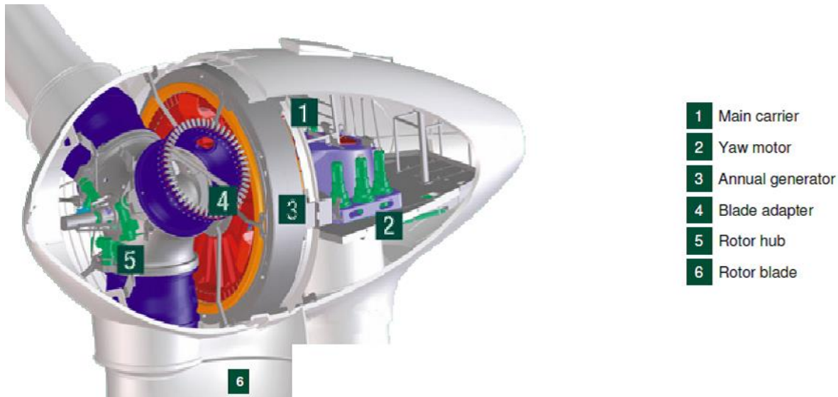
Εικόνα 6-3: Συστατικά μέρη ανεμογεννήτριας (Πηγή: Enercon)
