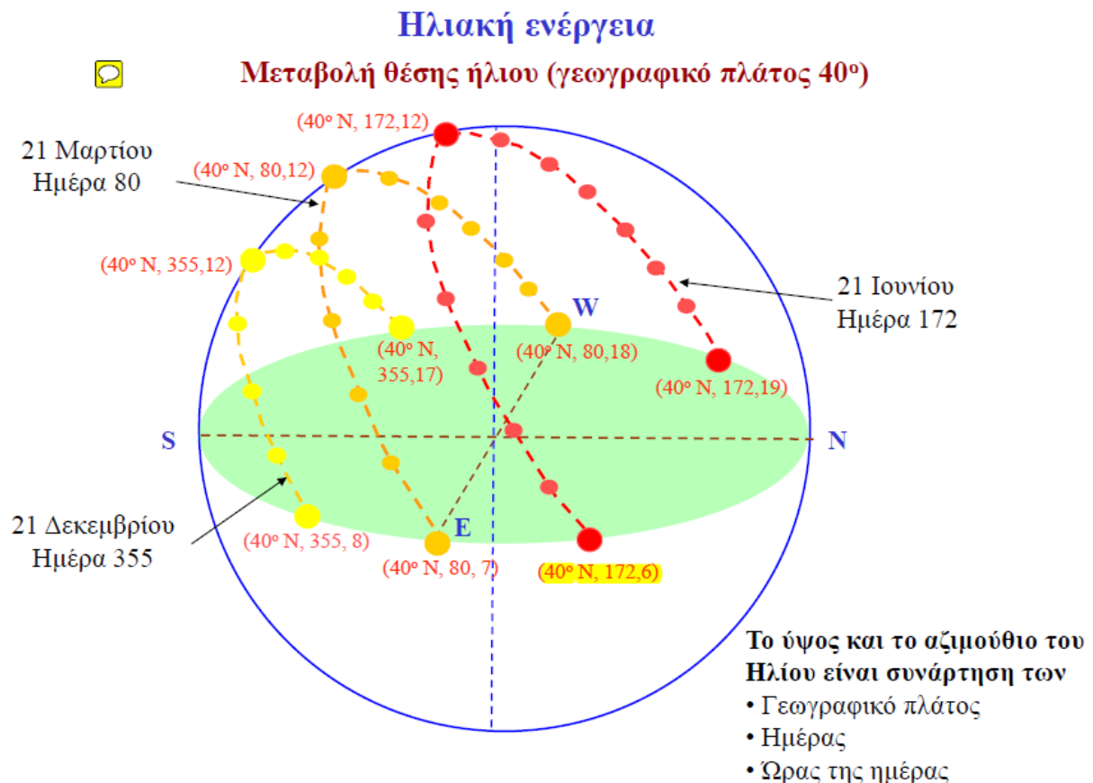
Εικόνα 1.2 : Θερινό και χειμερινό ηλιοστάσιο, φθινοπωρινή και εαρινή ισημερία για γεωγραφικό πλάτος 40^\circ στο βόρειο ημισφαίριο.
