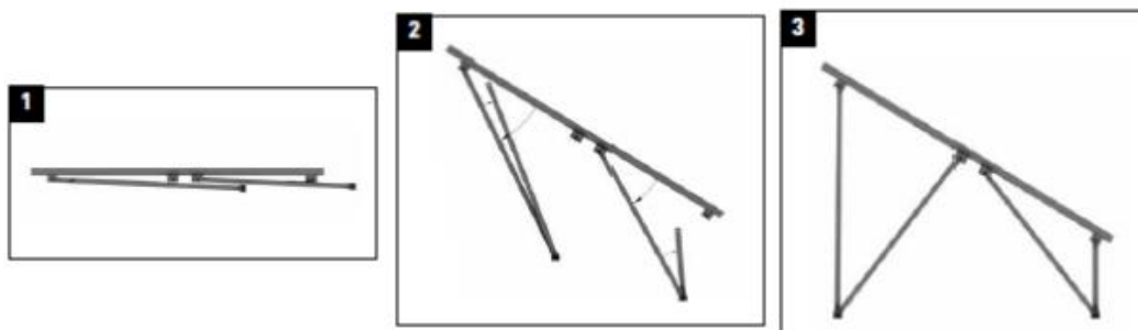
Εικόνα 2.30: Αναδιπλούμενο πλαίσιο από χάλυβα
