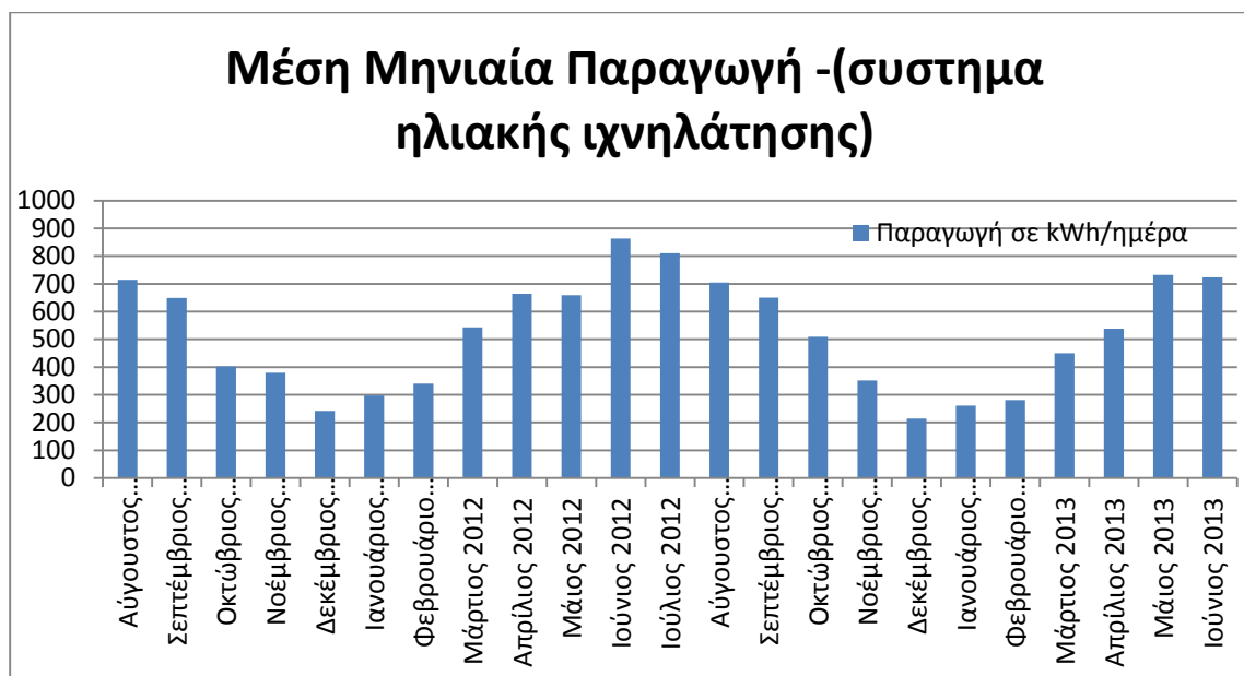
Σχήμα 3.1 : Χρονική εξέλιξη παραγωγής του φ/β σταθμού (μέση μηνιαία τιμή σε kWh/ημέρα)
