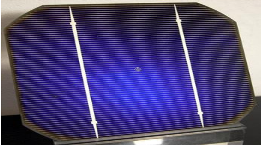
Εικόνα 1.8 : Πλαίσιο μονοκρυσταλλικού πυριτίου (πηγή http://www.m0ukd.com/Solar_Panels/ )
