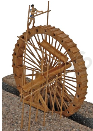
Εικόνα 2.2.4. Υποδιαιρεμένος τροχός τύπου πολυκαδίας του Φίλωνος ( www.kotsanas.com )
