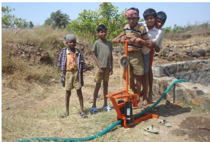
Εικόνα 5.4.5 Αντλία με πετάλια και δυο έμβολα (treadle pump) στην Ινδία τον 21 ο αι., προσφέρει παροχή 5 m 3 /h και ανύψωση 8 m ( www.tradeindia.com )
