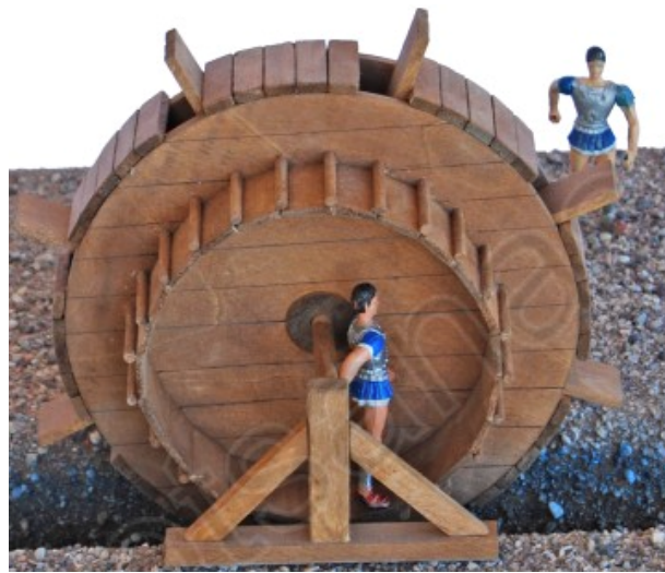
Εικόνα 3.4.2. Η κίνηση μέσω ποδοκίνητου τροχού (www.kotsanas.com)
