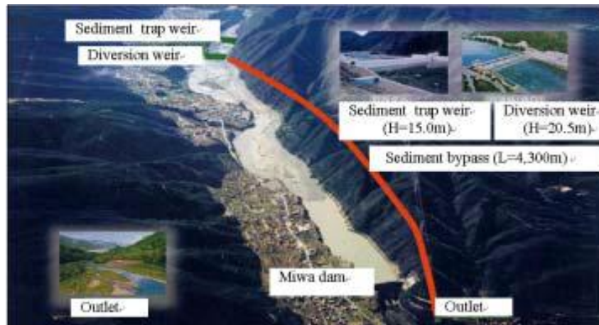
Εικόνα 4.4 Απεικόνιση του συστήματος εκτροπής του ταμιευτήρα Μίβα της Ιαπωνίας (Sumi et al,2004).
