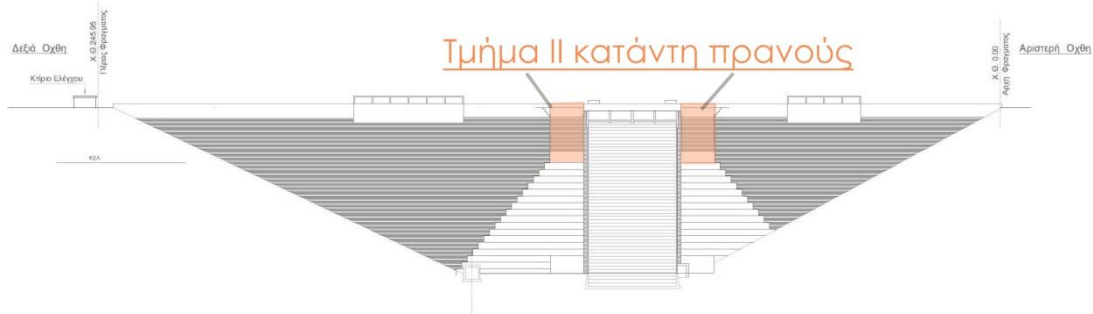
Εικόνα 11.3 Προσδιορισμός τμήματος II του κατάντη πρηνούς στην κατάντη όψη του φράγματος.
