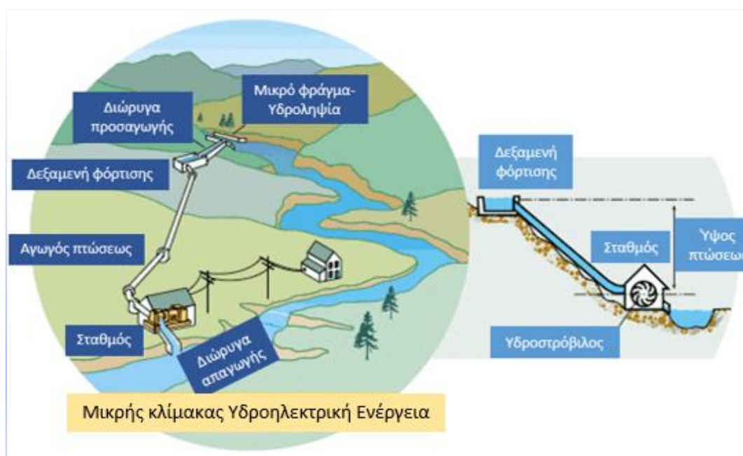
Εικόνα 1.3 Τυπική διάταξη ενός ΜΥΗΕ
