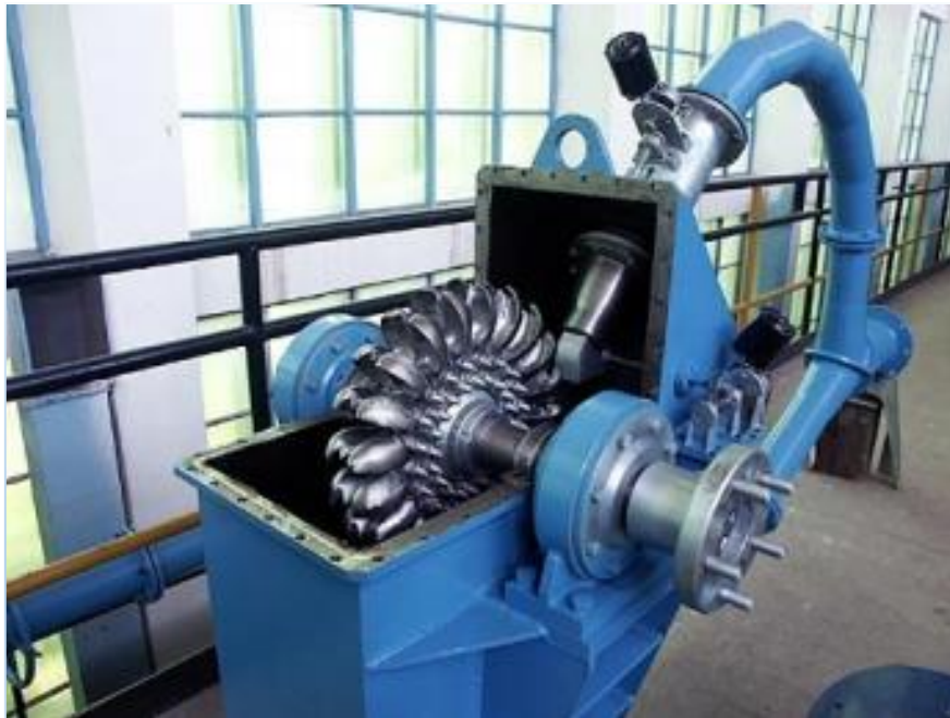
Εικόνα 2.10 Διάταξη υδροστροβίλου Pelton οριζοντίου άξονα περιστροφής με ένα ακροφύσιο
