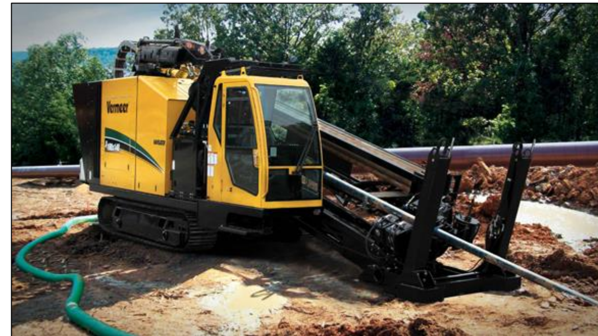
Εικόνα 7.17: Διατρητικό μηχάνημα μεθόδου Horizontal Directional Drilling
