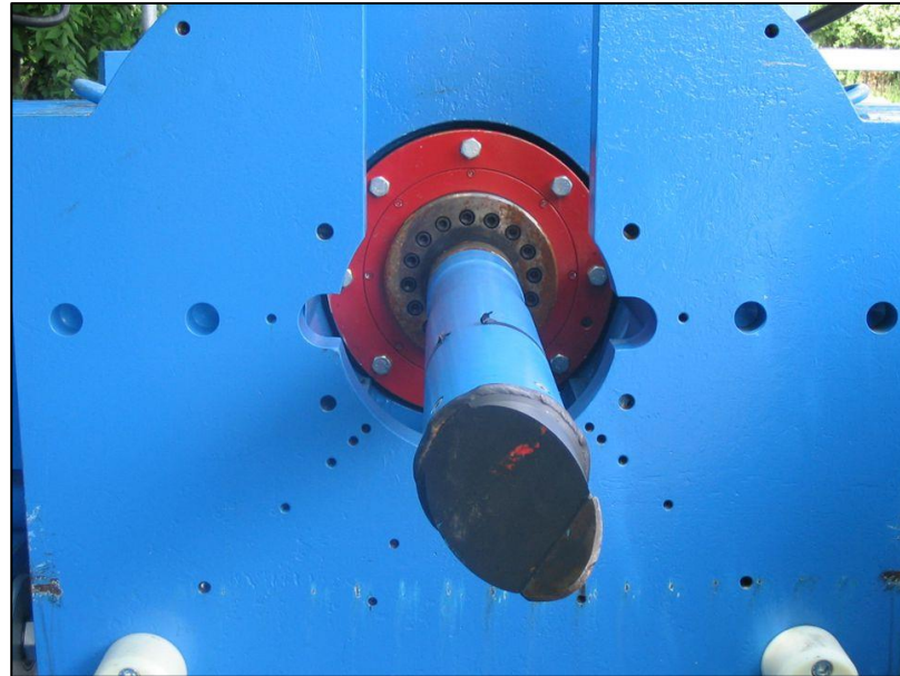
Εικόνα 7.3: Κατευθυνόμενη πιλοτική κεφαλή
