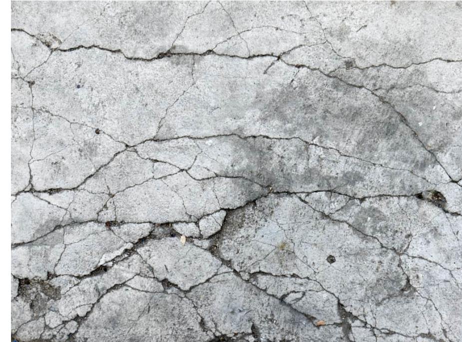
Εικόνα 9.1: Τυπική Αστοχία μετά από αρκετούς κύκλους ψύξης – απόψυξης
