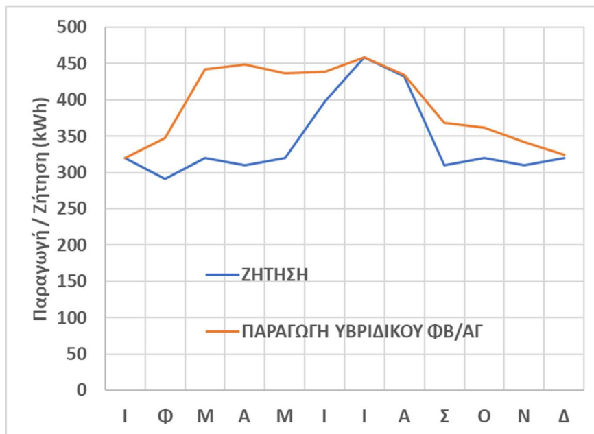
Σχήμα 9.24 Εξέλιξη της παραγωγής από το υβριδικό σύστημα σε σχέση με την ζήτηση
