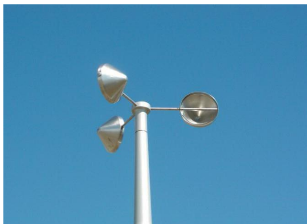
Εικόνα 3.10: Ανεμόμετρο κυπέλλου (πηγή: www.google.gr )
