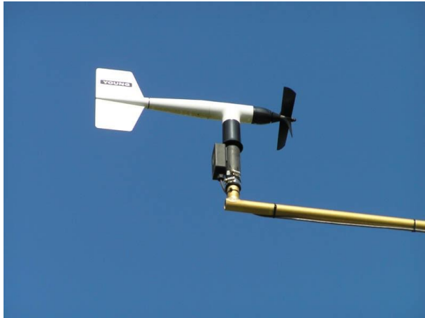
Εικόνα 3.11: Ανεμόμετρο έλικας (πηγή: www.noaa.com )
