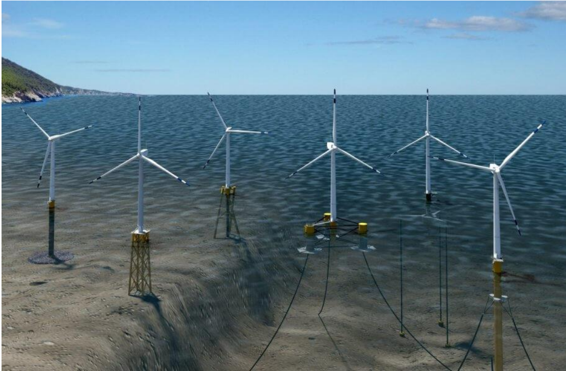
Εικόνα 3.7: Είδη έδρασης υπεράκτιων ανεμογεννητριών. Από αριστερά: monopile, jacket, twisted jacket, tension-leg floating platform, semi-submersible platform, and spar-buoy. (Πηγή: Josh Bauer/NREL)
