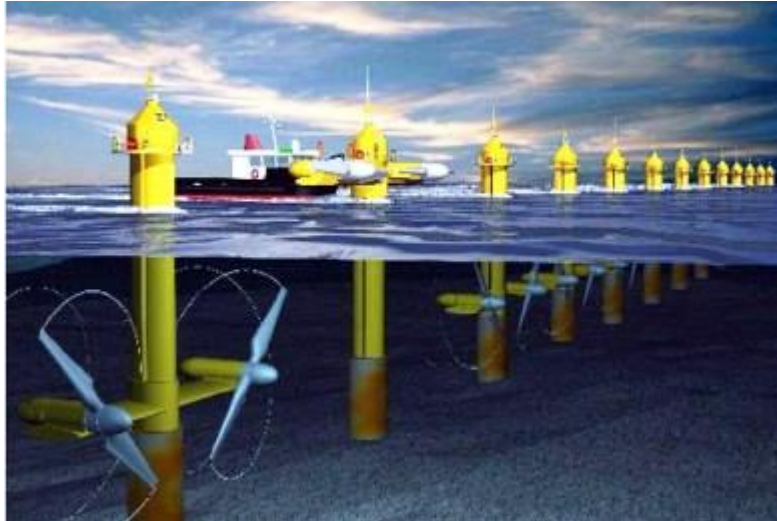
Εικόνα 2.2.7 Διάταξη Παραγωγής Ηλεκτρικού Ρεύματος από Παλιρροϊκή Ενέργεια
