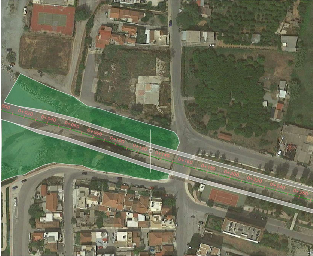
Σχήμα 69. Οριζοντιογραφία στην εκβολή (με πράσινο η δευτερεύουσα κοίτη και με άσπρο η διαπλάτυνση)
