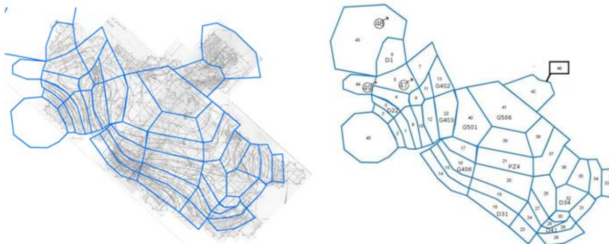
Σχήμα 6.5: Διακριτοποίηση υδροφορέας Δυτικής Θεσσαλίας με βάση τον πιεζομετρικό χάρτη της πεδινής περιοχής (αριστερά), αριθμηση κυττάρων και γεωτρήσεων παρατήρησης (δεξιά).
