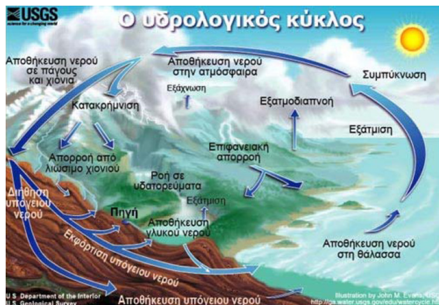
Διάγραμμα 1.1: Σχηματική απεικόνιση των διεργασιών του υδρολογικού κύκλου Πηγή: ( http://ga.water.usgs.gov/edu/watercyclegreekhi.html US Geological Survey)
