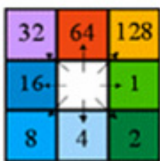
Σχήμα 3.1: Τιμή κεντρικού εικονοστοιχείου ανάλογα με τη διεύθυνση απορροής (Στάμου και Σκοπελίτη 2009)
