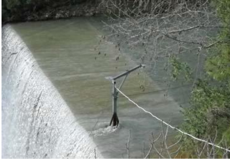
Φωτογραφία 4.4: Σταθμημετρικός σταθμός Νέδοντα (λατομείο Μπάκα).
