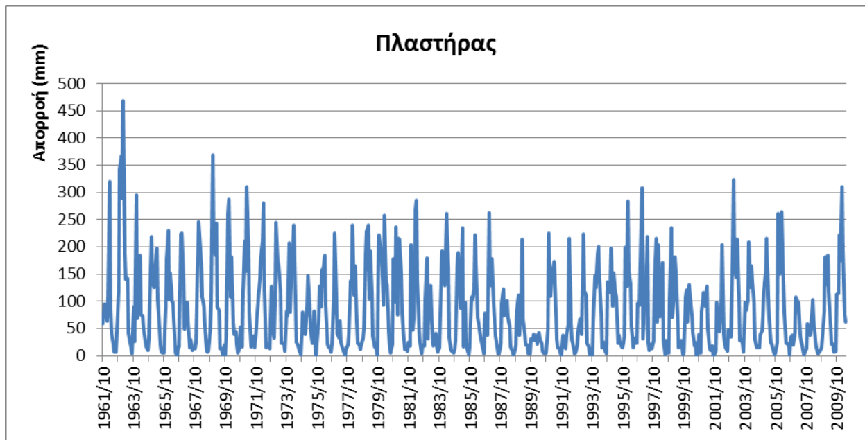
Εικόνα 6.5: Ιστορική χρονοσειρά απορροής ανάντη φράγματος Πλαστήρα.
