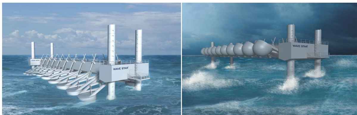
Εικόνα 2.12 Σχεδιαστική άποψη μονάδας ισχύος 600 kW. (Πηγή: Marquis L. et al., 2012)
