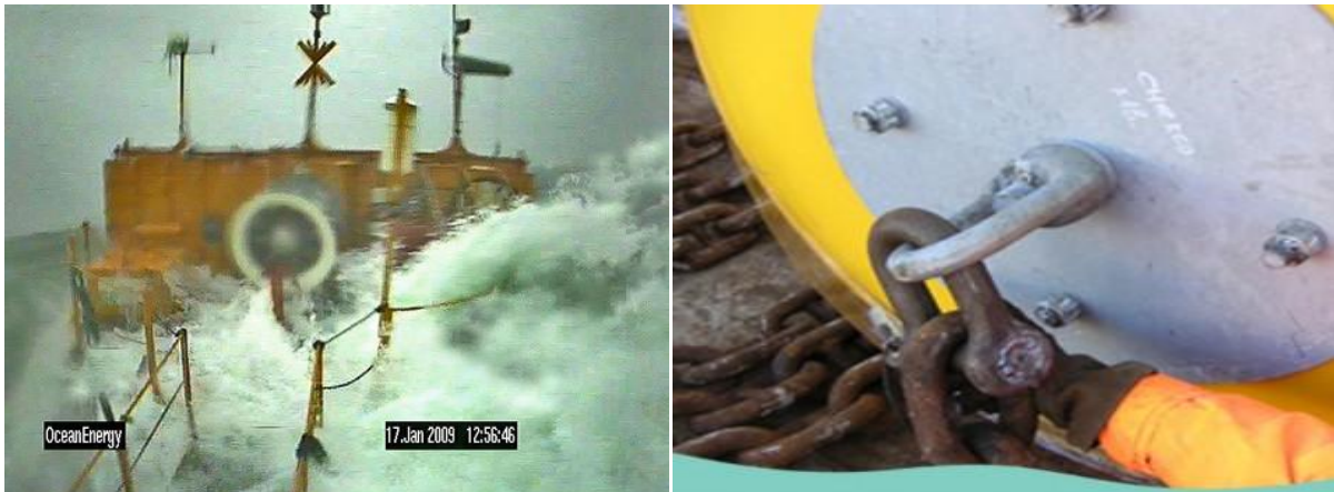
Εικόνα 2.9 Κυματικές – καιρικές συνθήκες και αγκυροβόληση της OE Buoy. (Πηγή: www.oceanenergy.ie )
