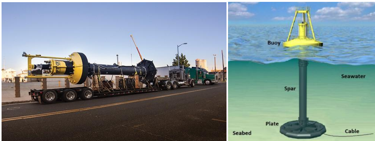
Εικόνα 2.15 Φωτογραφική και σχηματική απεικόνιση του Searaser PB3
