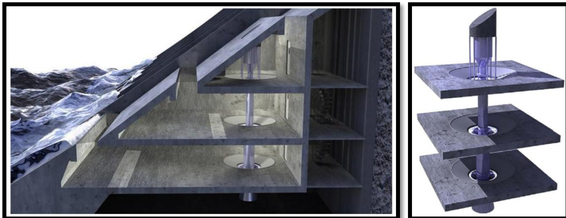
Εικόνα 3.8 Η κατακόρυφη διάταξη των υδραυλικών τουρμπινών (Πηγή: Vicinanza D. et al., 2012)
