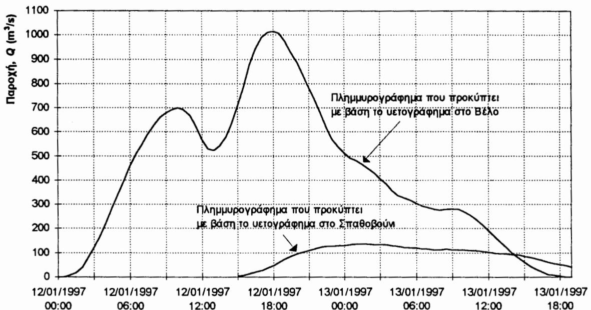
Σχ. 21 Υποθετικά πλημμυρογραφήματα του χειμάρρου Ξηριά (θέση Γέφυρας Εθνικής Οδού) που θα προέκυπταν αν η επιφανειακή βροχόπτωση στη λεκάνη στις 12/1/1997 ήταν ίση με τη σημειακή βροχόπτωση που καταγράφηκε (α) στο Βέλο και (β) στο Σπαθοβούνι.
