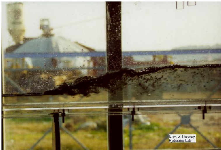
Σχήμα 3.8 Το υδραυλικό άλμα στο εργαστήριο (Παπανικολάου 5 2001).
