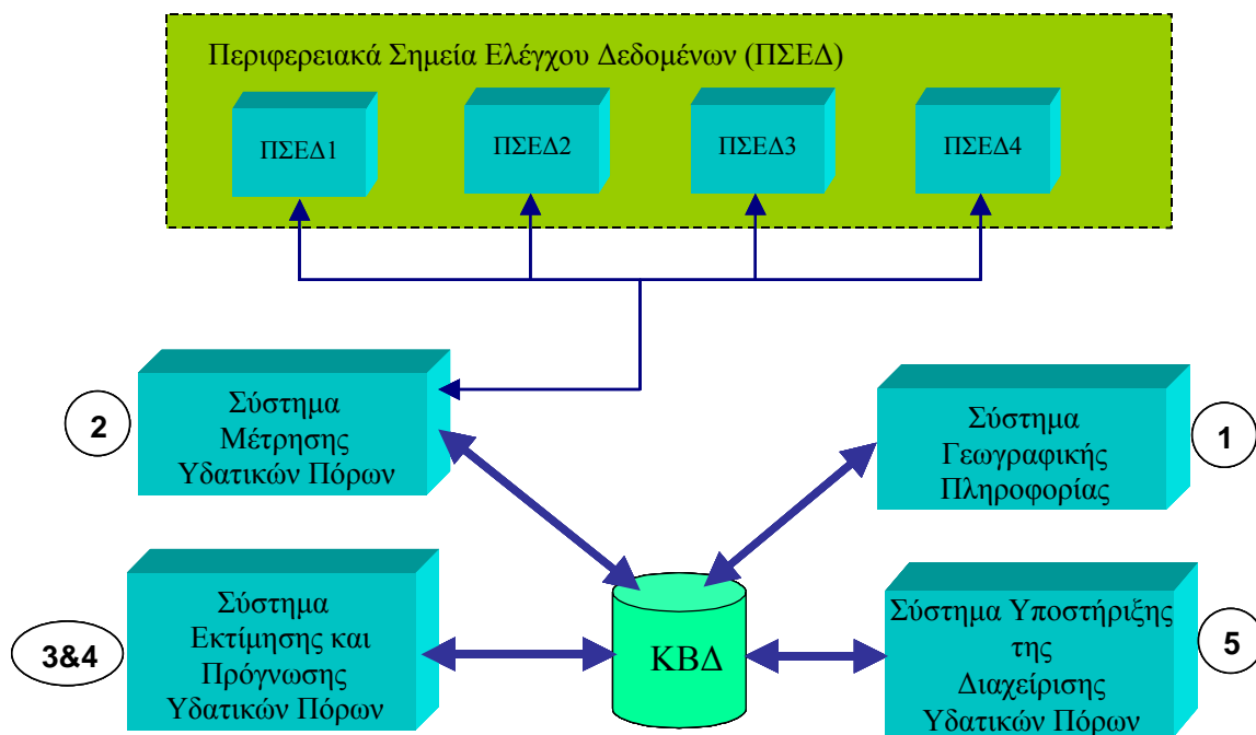
Σχήμα 2.1: Γενική αρχιτεκτονική πληροφοριακού συστήματος του έργου
