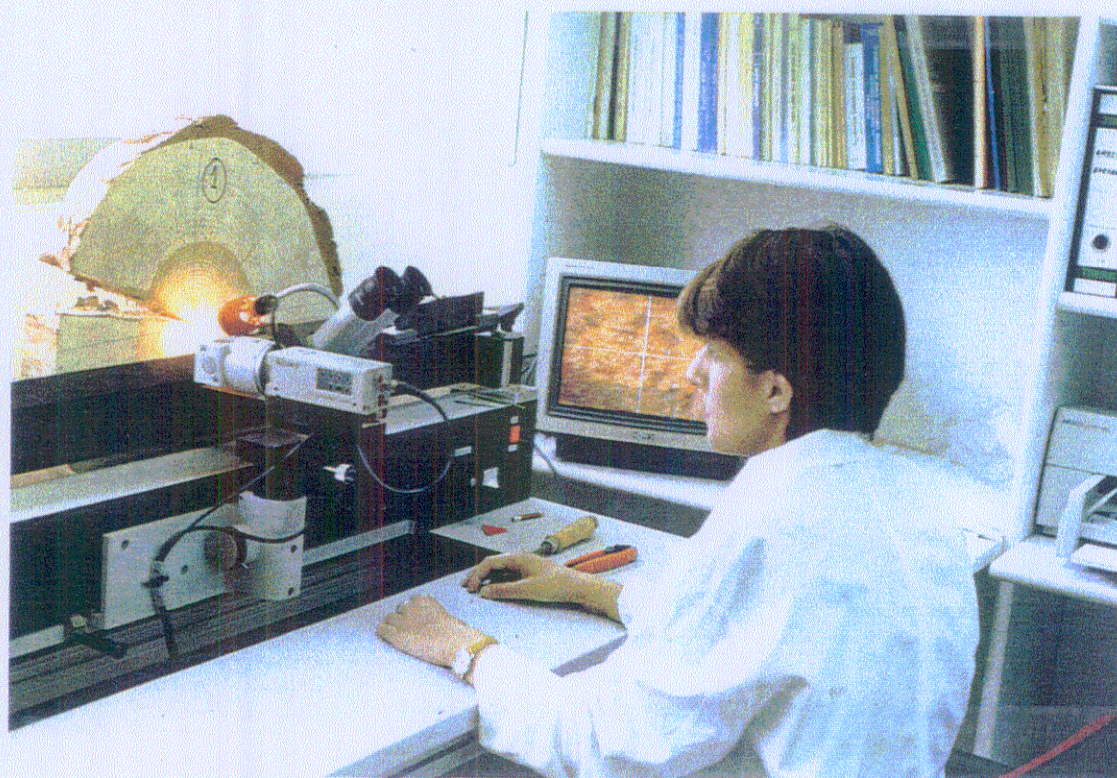
Φωτογραφία 4: Μέτρηση του πλάτους των αυξητικών δακτυλίων Digitalpositionmeter.
