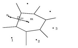
$$G_{\rm m} V_{\rm m} + \sum_{\rm n} K_{\rm mn} \frac{h_{\rm n} - h_{\rm m}}{D_{\rm mn}} A_{\rm mn} = SS_{\rm m} V_{\rm m} \frac{\Delta h_{\rm m}}{\Delta t} \quad (3.1)$$
