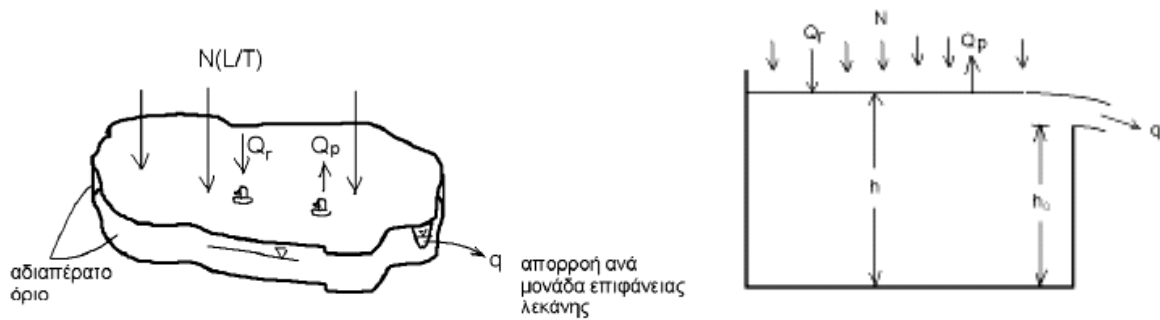
Εικόνα 20: Αναπαράσταση του υδροφορέα και της υπόγειας δεξαμενής σε μοντέλο ενός κυττάρου (Πηγή: Μαντόγλου, 2004).
