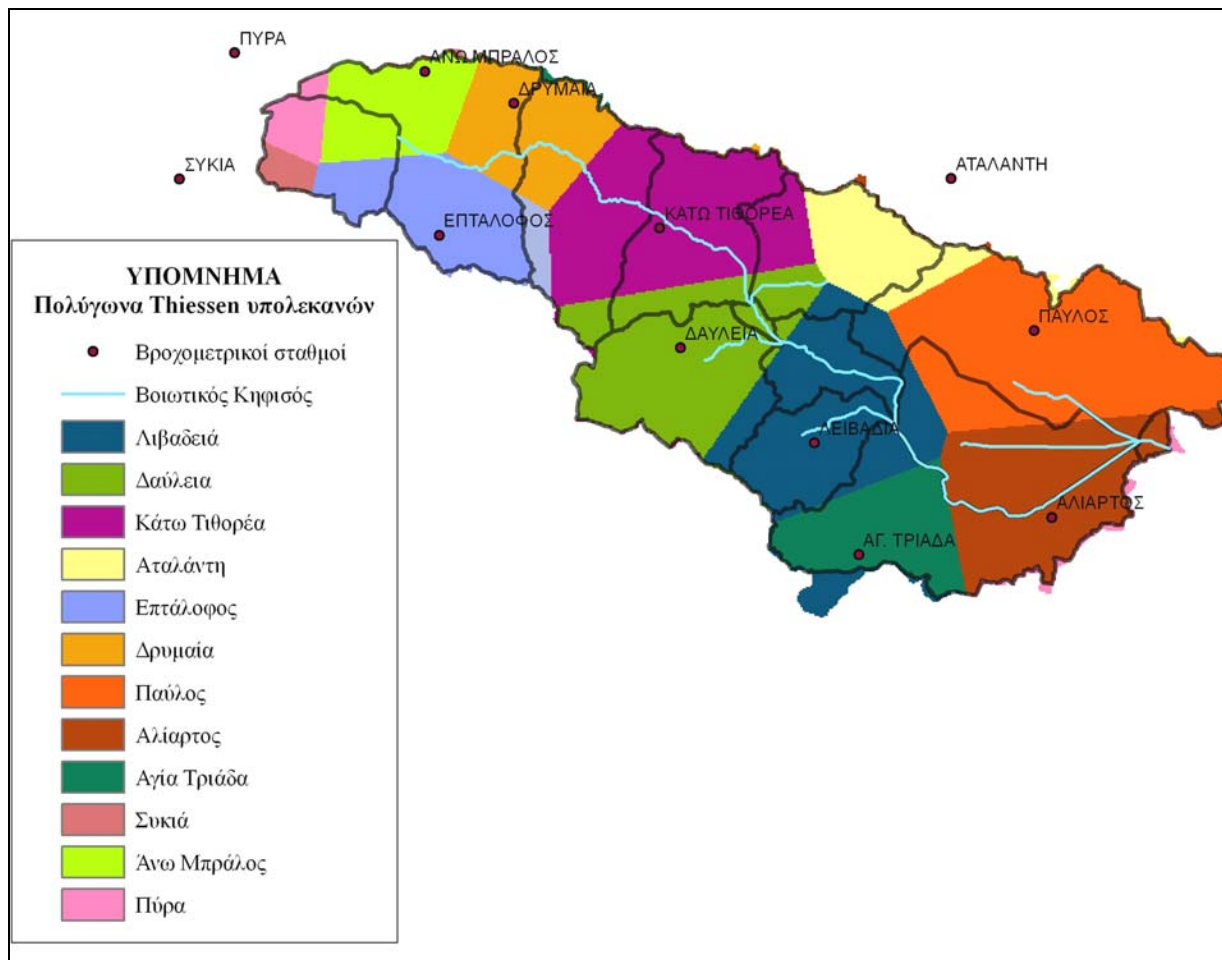
Εικόνα 31: Σχεδιασμός των πολυγώνων Thiessen σε κάθε υπολεκάνη του Βοιωτικού Κηφισού. Κάθε χρώμα αντιστοιχεί στην περιοχή επιρροής ενός σταθμού. Τα χρώματα στο εσωτερικό κάθε υπολεκάνης δείχνουν από ποιους σταθμούς επηρεάζεται.
