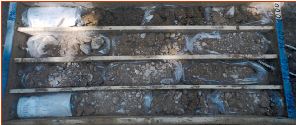
Πρόσφατες αποθέσεις της παλαιάς κοίτης Θέση: Ιερή Ελιά, βάθος: 8,5 - 13,5 m
