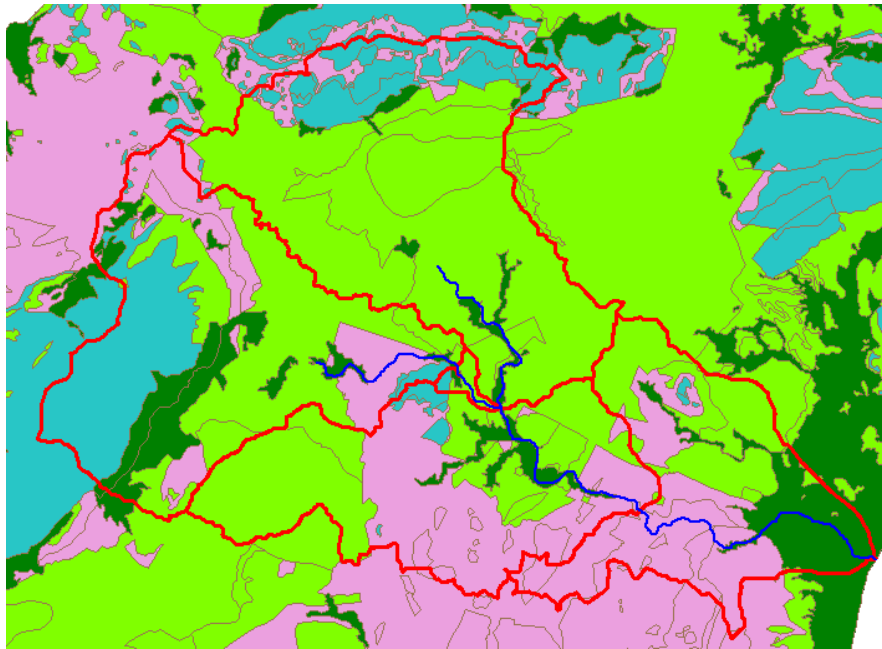
Εικόνα 1.24: Τομή υπολεκανών και μονάδων υδρολογικής απόκρισης λεκάνης Γαδουρά.
