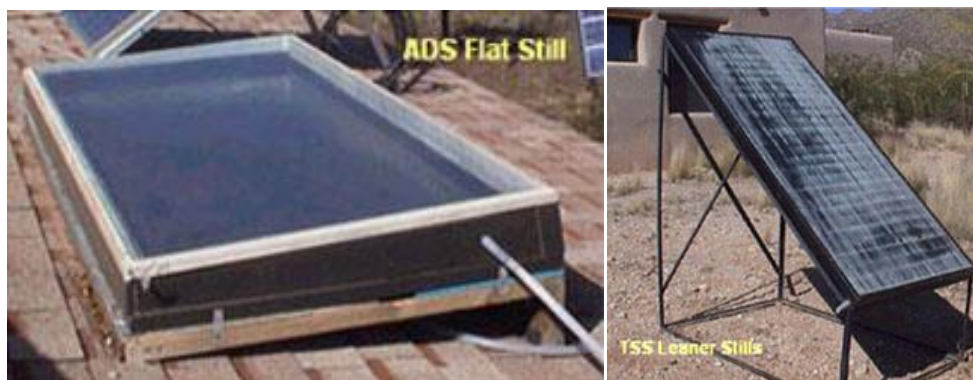
Εικόνα 3-10. Ηλιακοί αποστακτήρες, για οικιακή χρήση (TERRA.ORG, 2005)
