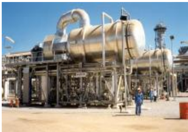
Εικόνα 3-9. Φωτογραφία εγκατάστασης Απόσταξης με Συμπύεση Ατμών (Τζέν Ε. , Αφαλάτωση Νερού με χρήση ΑΠΕ, 2010)
