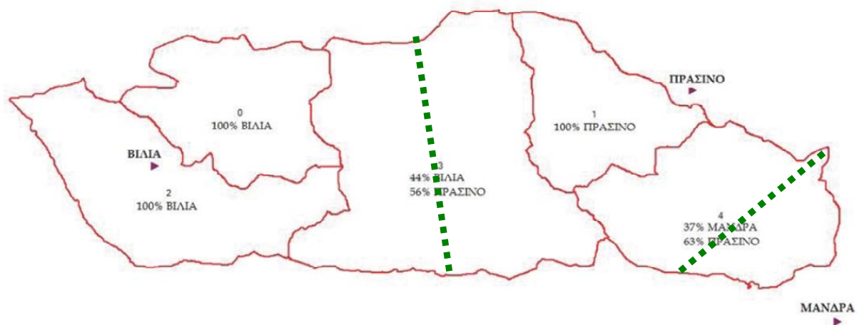
Σχήμα 4.3: Υπολεκάνες Σαρανταπόταμου και χάραξη πολυγώνων Thiessen, με βάση τους βροχομετρικούς σταθμούς Μάνδρας, Πράσινου και Βιλίων.
