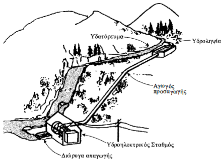
Εικόνα 3: Αρχή διαμόρφωσης μικρού ΥΗΕ με κλειστό αγωγό προσαγωγής (Παπαντώνης, 2008)
