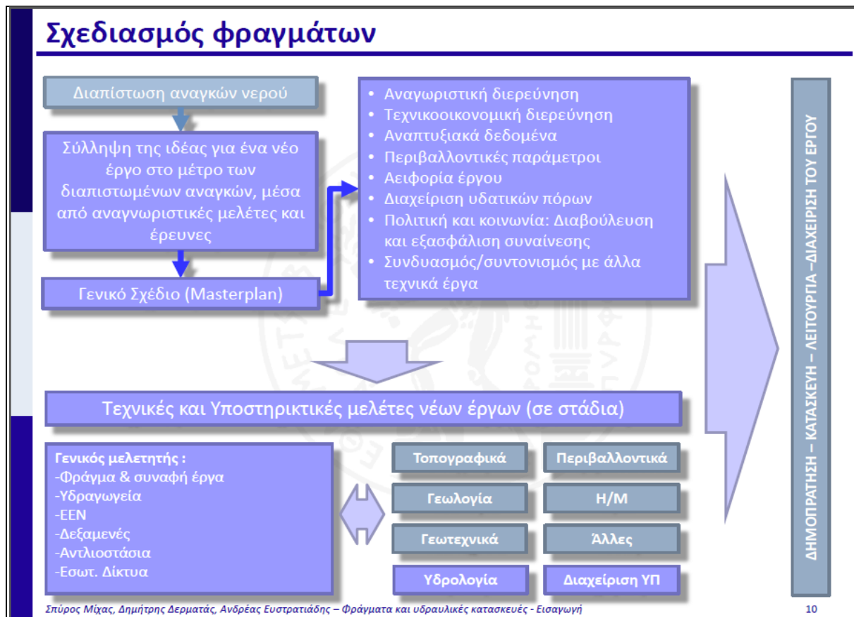
Εικόνα 37 : Πίνακας σχεδιασμού φραγμάτων
