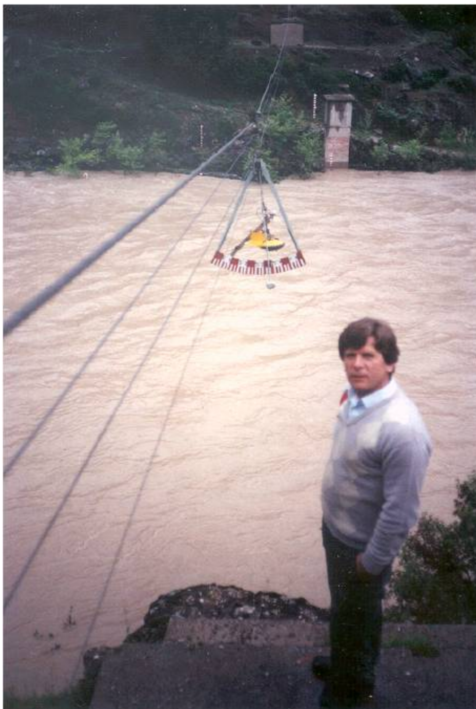
Σχ. 6: Ο πλημμυρισμένος Αχελώος στη θέση Αυλάκι (ανάντη του ταμιευτήρα Κρεμαστών) και η ανθρώπινη και τεχνική υποδομή για τη μέτρησή του: Μπροστά ο ειδικευμένος υδρομετρητής της ΔΕΗ κ. Χρήστος Αλβανός. Στην εναέρια καλωδίωση είναι αναρτημένα όργανα για τη μέτρηση της ταχύτητας του ποταμού (μυλίσκος με τα απαραίτητα εξαρτήματα). Στην απέναντι όχθη φαίνεται μια σειρά από σταθμήμετρα (κατακόρυφες ράβδοι) και ο οικίσκος που φιλοξενεί εγκαταστάσεις και όργανα για τον αυτοματισμό της μέτρησης της στάθμης (σταθμηγράφο). (Φωτογραφία από το αρχείο της ΔΕΗ/ΔΑΥΕ/ΤΣΜΥΣ/Κλιμάκιο Αργινίου.)
