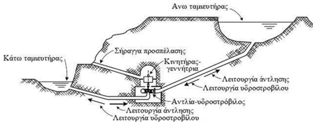
Σχήμα 2.16 Σχηματική απεικόνιση της λειτουργίας ενός συστήματος αντλησιοταμίευσης (Παπαντώνης, 2009)
