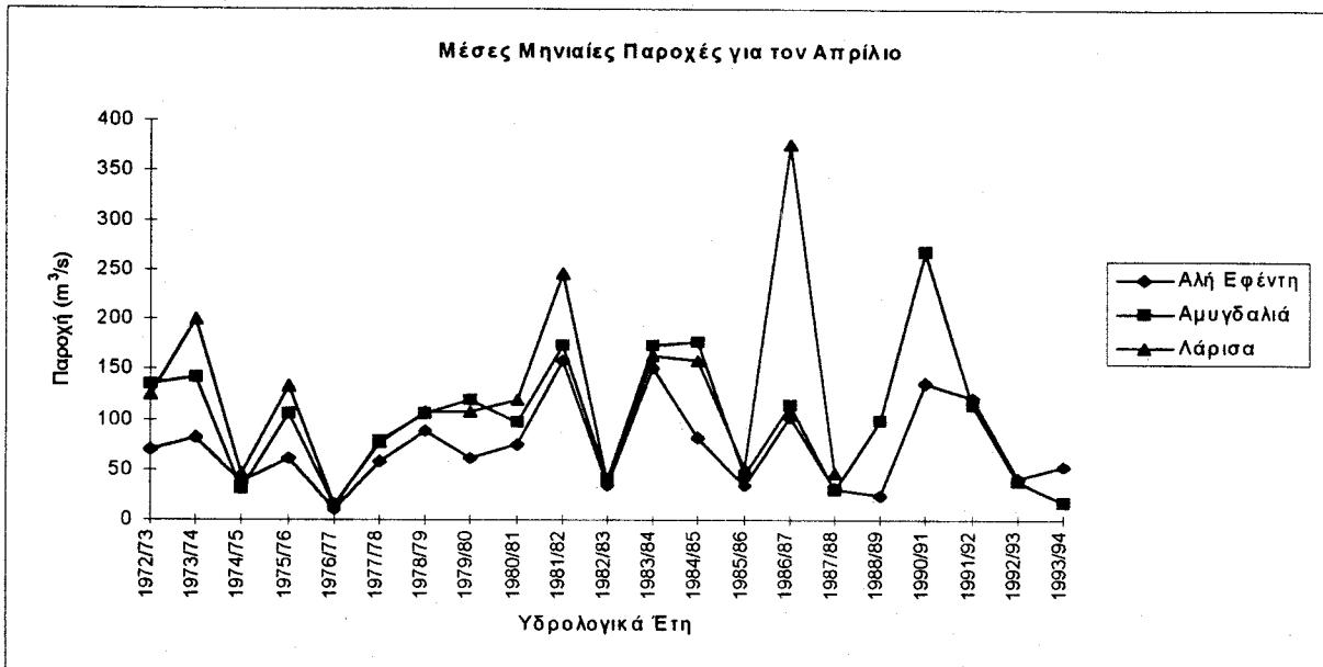
**Σχήμα 5.2 Μέσες μηνιαίες παροχές Απριλίου για τα υδρολογικά έτη 1972/73 έως 1993/94**
