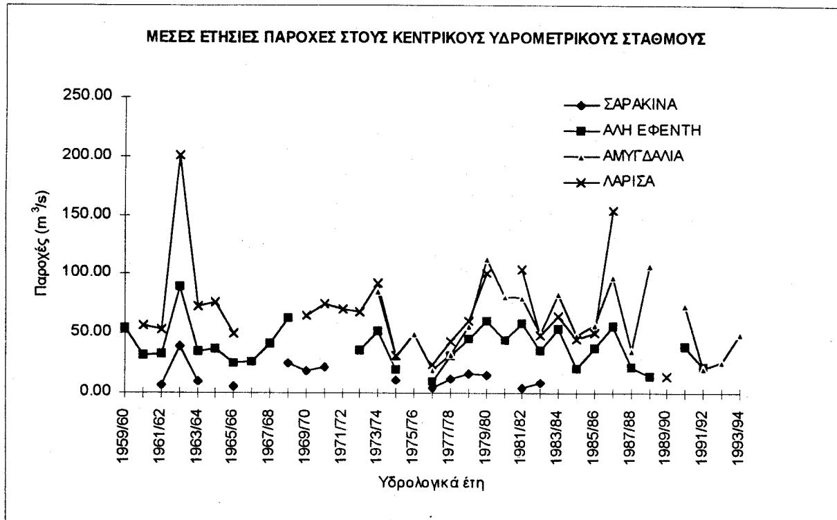
**Σχήμα 5.1 Σύγκριση των μέσων ετήσιων παροχών στους υδρομετρικούς σταθμούς της Κεντρικής Θεσσαλίας.**
