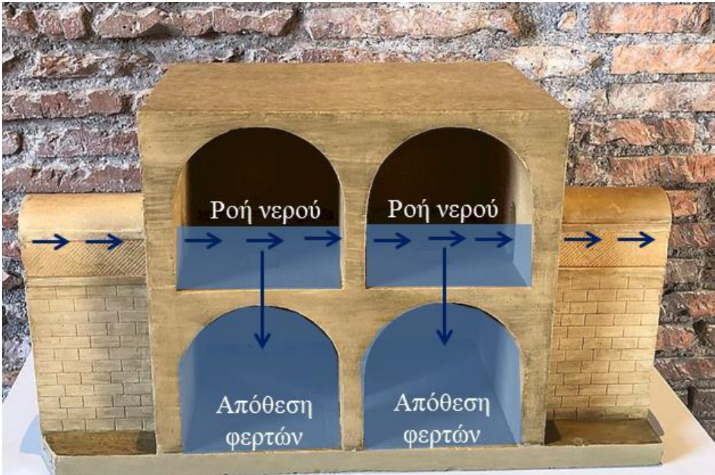
Δεξαμενή καθίζησης (Piscina limaria) στο υδραγωγείο Virgo της Ρώμης
