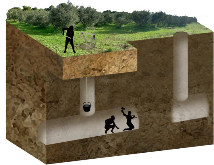
Κατασκευή της σήραγγας του Αδριάνειου υδραγωγείου
