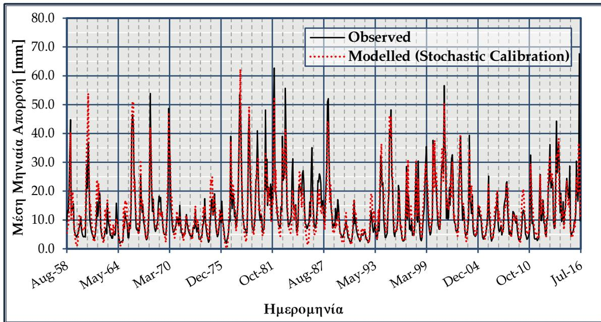
Σχήμα 3 | Οπτική επισκόπηση της συμφωνίας μεταξύ των παρατηρημένων (observed) και μοντελοποιημένων (modelled) τιμών απορροής με χρήση της μεθοδολογίας της στοχαστικής βαθμονόμησης και του υδρολογικού μοντέλου Zygos6P
