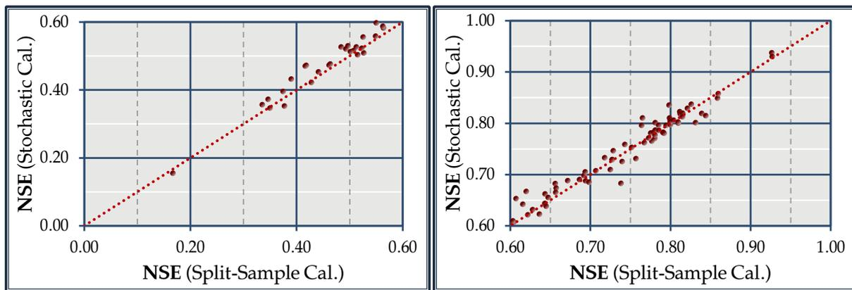
Σχήμα 6 | Διαγράμματα διασποράς χαμηλής (αριστερά) και υψηλής (δεξιά) επίδοσης (NSE) για το μοντέλο Zygos4P, με εφαρμογή της μεθοδολογίας ρύθμισης με βάση τα ιστορικά δεδομένα (Split-Sample Cal.) και της στοχαστικής βαθμονόμησης (Stochastic Cal.)
