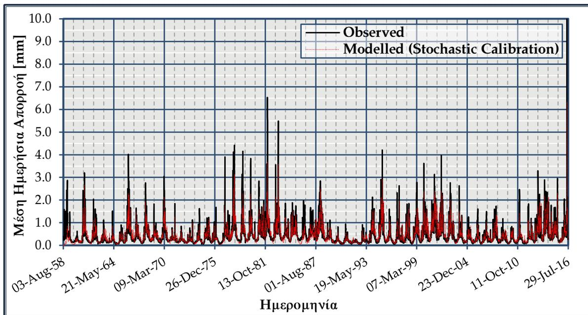
Σχήμα 4 | Οπτική επισκόπηση της συμφωνίας μεταξύ των παρατηρημένων (observed) και μοντελοποιημένων (modelled) τιμών απορροής με χρήση της μεθοδολογίας της στοχαστικής βαθμονόμησης και του υδρολογικού μοντέλου GR4J
