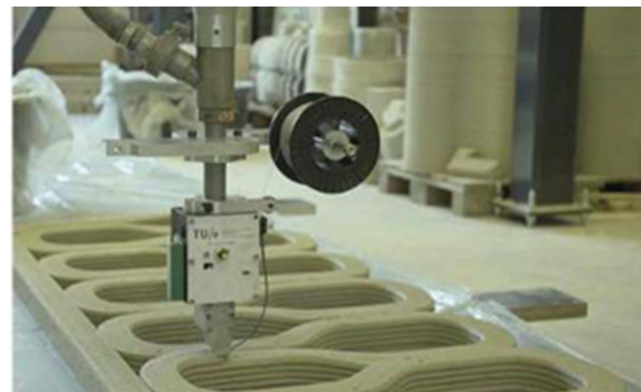
Εικ1, α. Εκτυπωτής σκυροδέματος, Eindhoven-University-of-Technology
