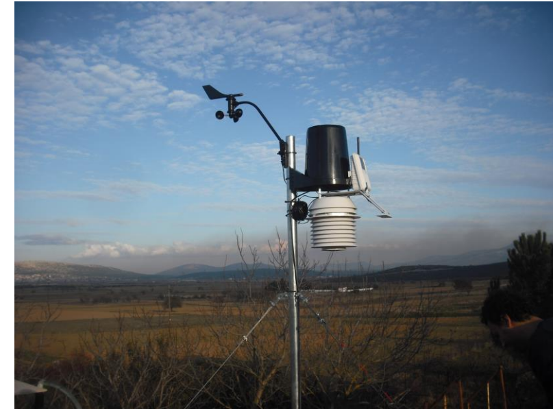
Αυτόματος μετεωρολογικός σταθμός τύπου Davis (Πράσινο Βοιωτίας)
