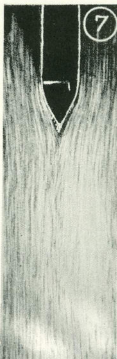
Ἐπίδρασις τῆς ἀναρροφήσεως τῆς ὀριαυῆς στοιβάδος εἰς τὴν λειτουργίαν ὑδραυλικῶν ἔργων: Βάθρον γεφύρας (6, 7) Γωνία εἰς ἀνοικτὴν διώρυγα (8, 9)- Ἐυτροπή ὑδατίνης δέσεως (10, 11, 12)
