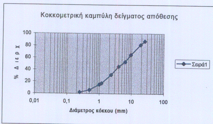
Διάγραμμα 4.4. : Κοκκομετρική Καμπύλη Δείγματος Απόθεσης Πτολεμαΐδος και Πάρνηθος
