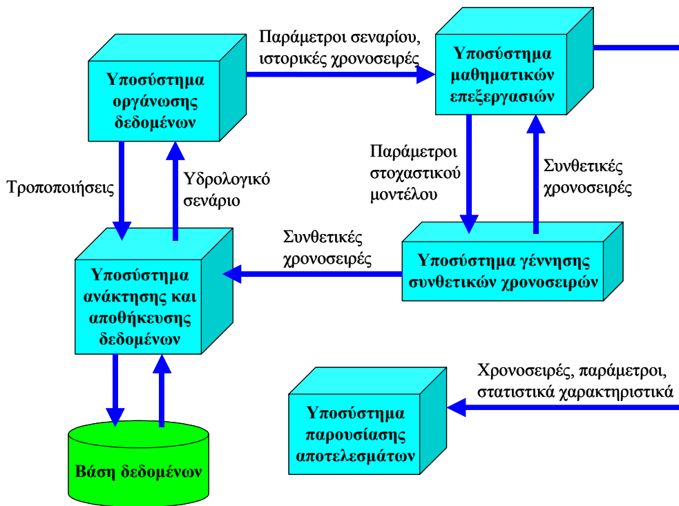
Σχήμα 4.1: Αρχιτεκτονικός σχεδιασμός και υποσυστήματα Κασταλίας.
