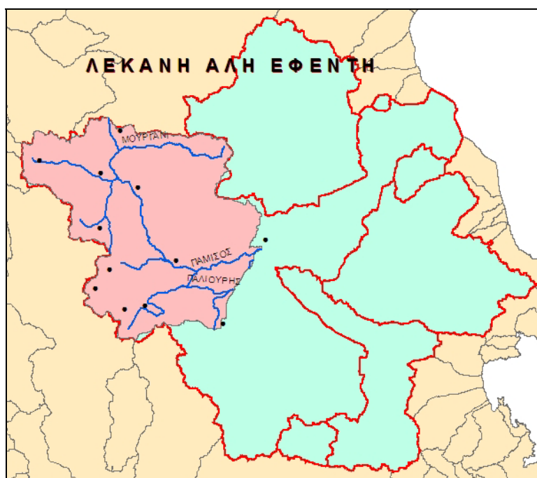
Εικ. 4: Η λεκάνη του Αλή Εφέντη έχει Εμβαδόν: 2792 Km 2 και Περίμετρο: 397700 m
