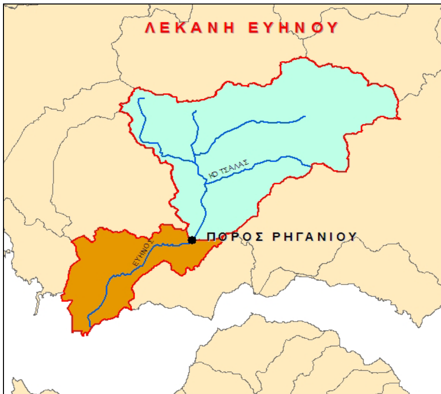
Εικ. 3: Θέση υδρολογικής λεκάνης ανάντη του υδρομετεωρολογικού σταθμού Πόρου Ρηγανίου
