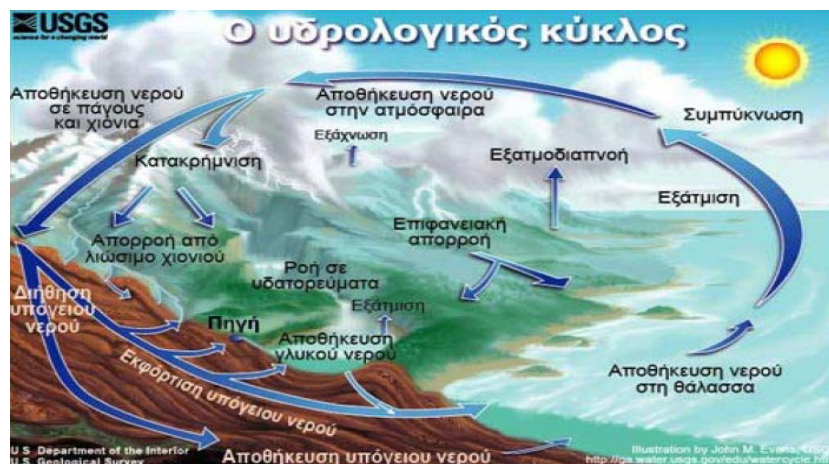
Εικόνα 1.1. Σχηματική απεικόνιση των διεργασιών του υδρολογικού κύκλου (πηγή: http://ga.water.usgs.gov/edu/watercyclegreekhi.html US Geological Survey)
