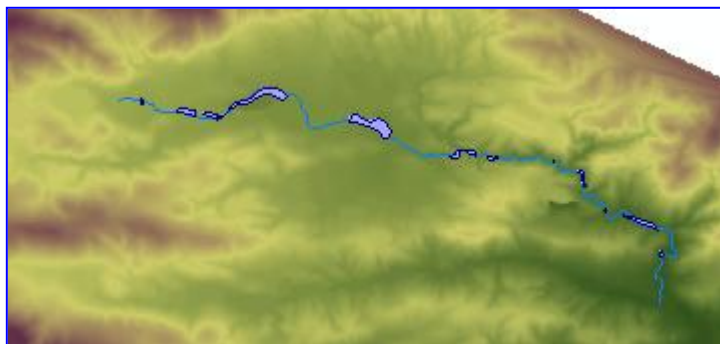
Εικόνα 6.4. Τα βάθη και η έκταση πλημμύρας για περίοδο επαναφοράς T=20 έτη.
