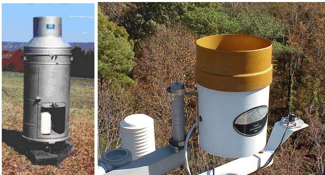
Σχήμα 2.5. Αριστερά: τυπικό βροχόμετρο, Δεξιά: ηλεκτρονικό βροχόμετρο (Πηγή: Αναγνωστοπούλου, 2006)
