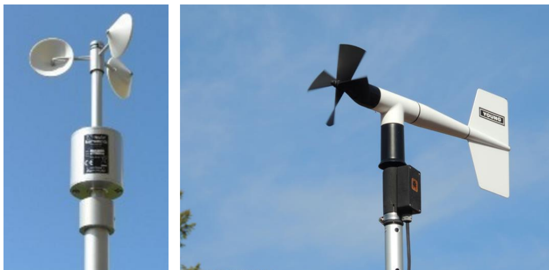
Σχήμα 2.4. Αριστερά: καπελλοφόρο ανεμόμετρο, Δεξιά: ανεμόμετρο έλικας (Πηγή: http://www.northmeteo.gr/bibliothiki/meteorologia/meteorologikoi-stathmoi/ )
