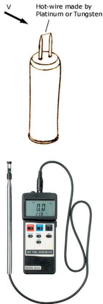
Σχήμα 2.8. Στην πρώτη φωτογραφία είναι η βασική μορφή ενός ανεμόμετρου θερμού σύρματος (“eFunda: Introduction to Hot-Wire Anemometers,” n.d.) και στη δεύτερη η πιο σύγχρονη εκδοχή της συσκευής (“REED AM-4204 Hot Wire Anemometer w/ RS232 Output,” n.d.).
