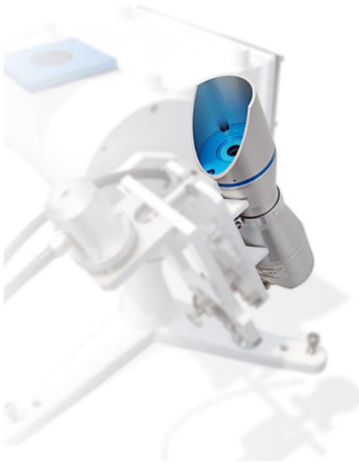
Σχήμα 2.3 : Το όργανο πυρηλιόμετρο
