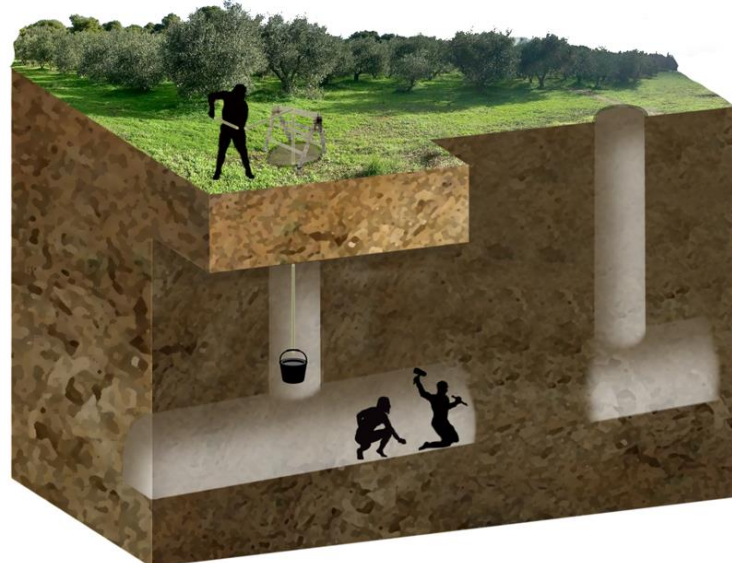
Κατασκευή της σήραγγας του Αδριάνειου υδραγωγείου
