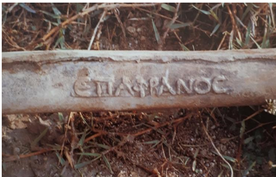
Εικόνα 18. Μολύβδινος αγωγός σταγονόσχημης διατομής με σφράγισμα από την οικία Διονύσου. Πηγή: Παντερμαλής, 1999, σελ.183
